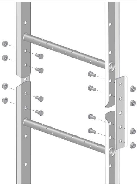
Skarva stegen med skarvplåt och 4st M10x20 bult + mutter.
