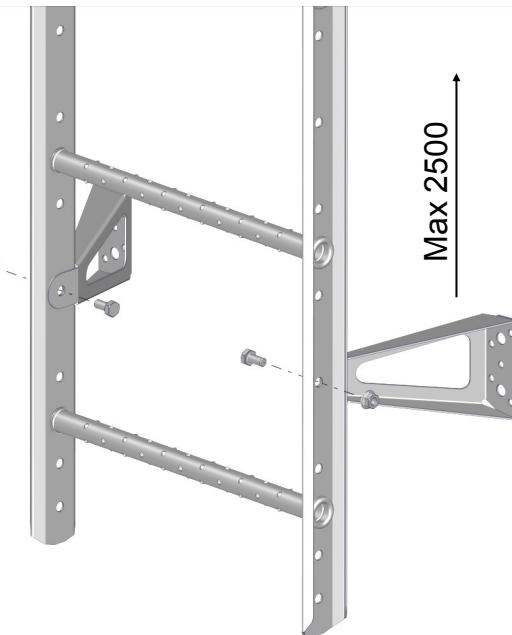
Montera resterande konsoler med max c/c avstånd på 2500mm.
