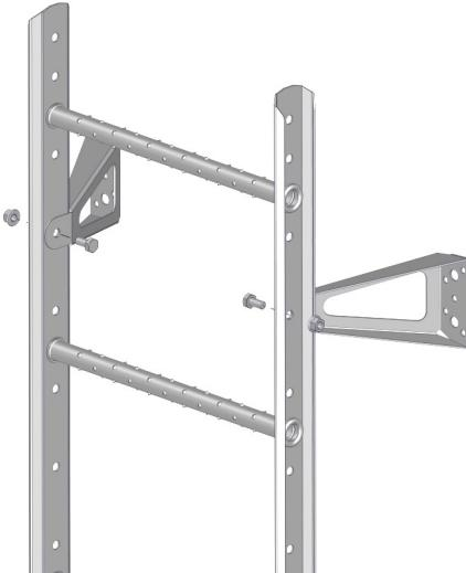
Montera stegen till de översta konsolparet med 2st M10x20 + mutter och se till så översta pinnen hamnar **minst 30mm över takkanten**.
